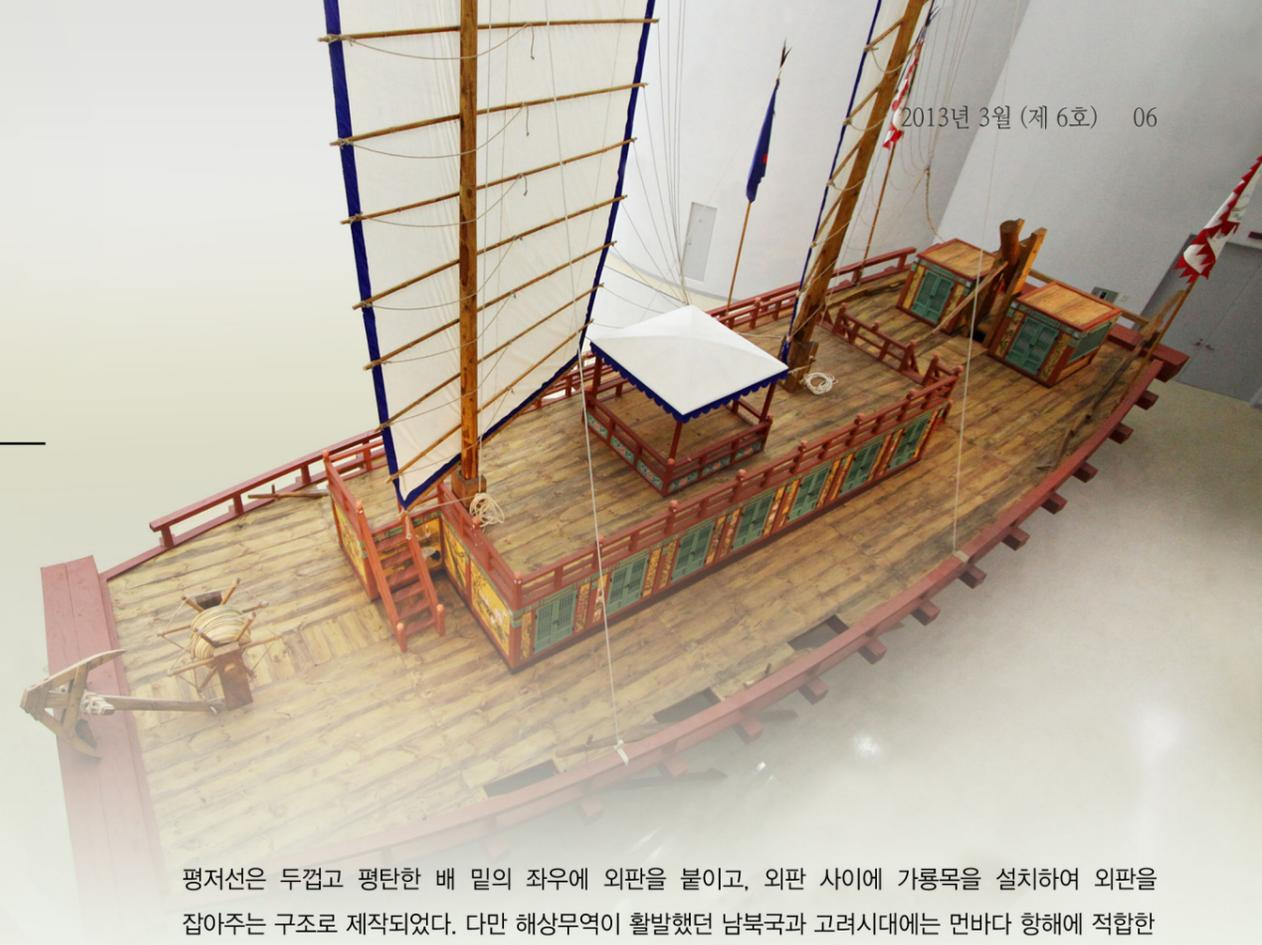
평저선은 두껍고 평탄한 배 밑의 좌우에 외판을 붙이고, 외판 사이에 가로목을 설치하여 외판을 잡아주는 구조로 제작되었다. 다만 해상무역이 활발했던 남북국과 고려시대에는 먼바다 항해에 적합한 '첨저선 尖底線'에 가까운 평저선 구조의 배가 제작되기도 하였다.
